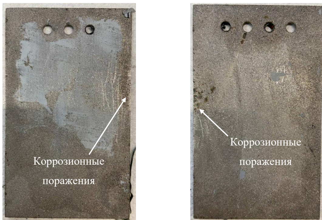
Рисунок 4 – Внешний вид образцов с надрезом после удаления покрытия
